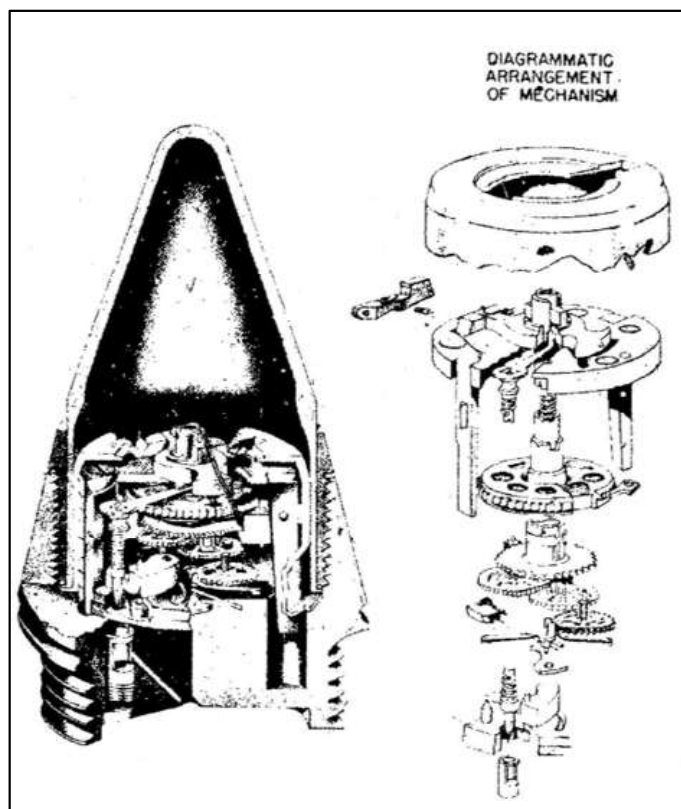
Eksempel på brannrør: Zt.Zs 30 tidsbrannrør (TM 9-1985-3)
