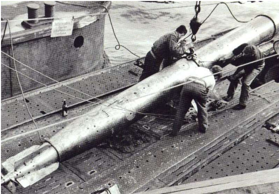
Lasting av G7e(TIII) torpedo på en Kriegsmarine-ubåt under 2. verdenskrig (Bundesarchiv)
