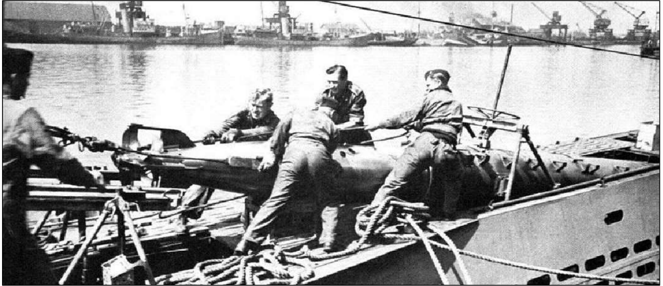
G7a(TI) torpedo hales inn i beholder for reservetorpedo på dekk av en ukjent ubåt (U-Historia)
