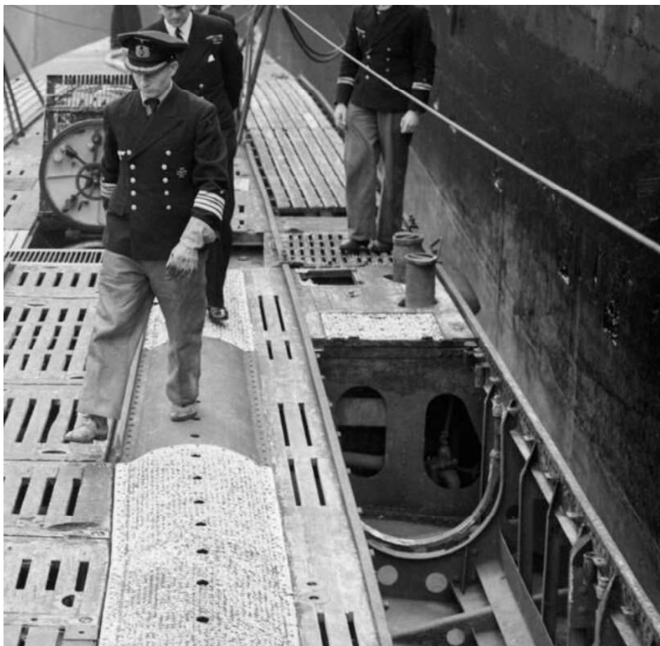
Logistikkcontainerne på U-532 akterdekk, hvor en er løftet ut (Imperial War Museum, foto A-28762)
