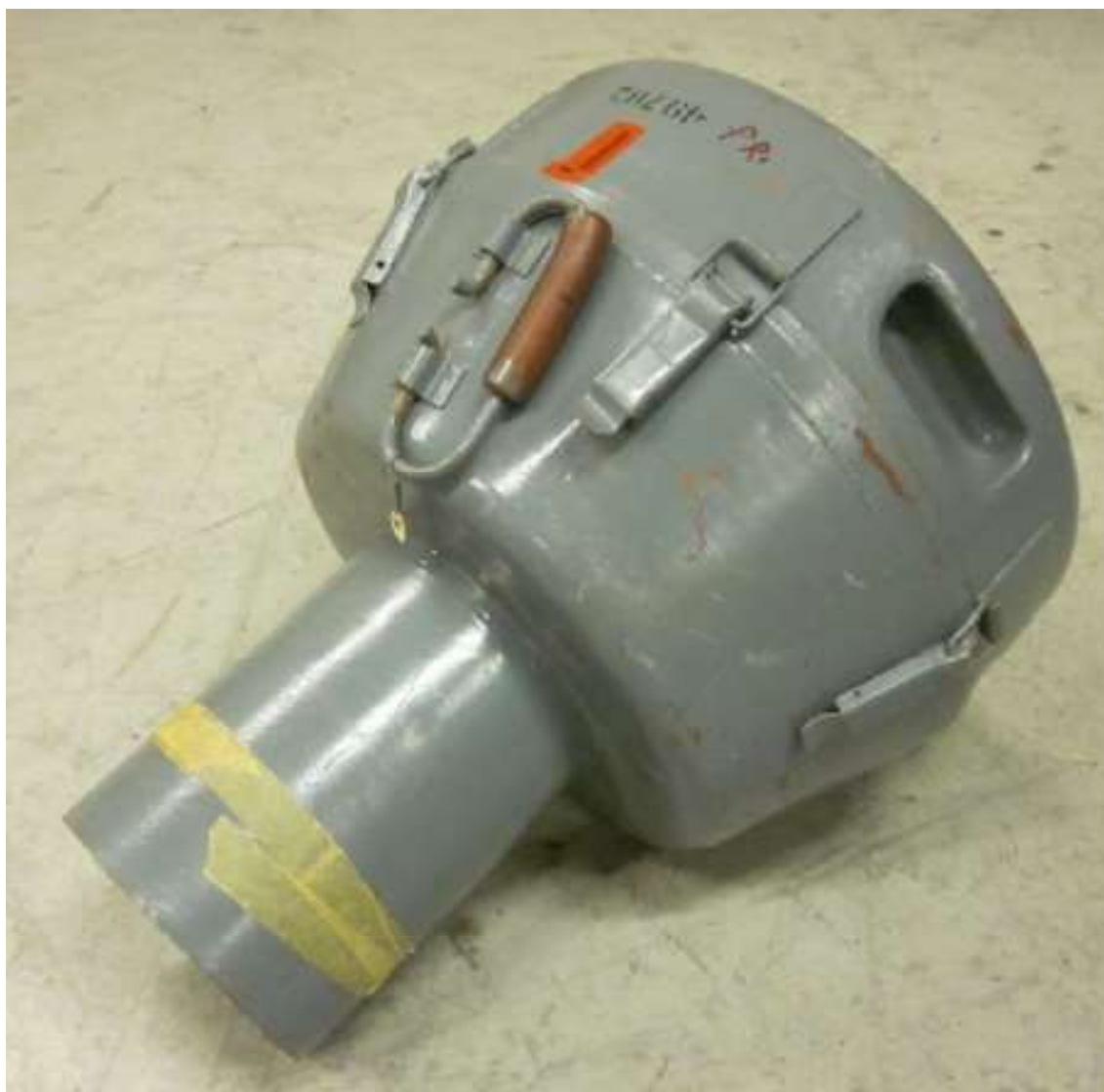
Oppbevaringskontainer for Pi 1 tennapparat som ikke er montert på torpedo (Håvard Hovdet)
