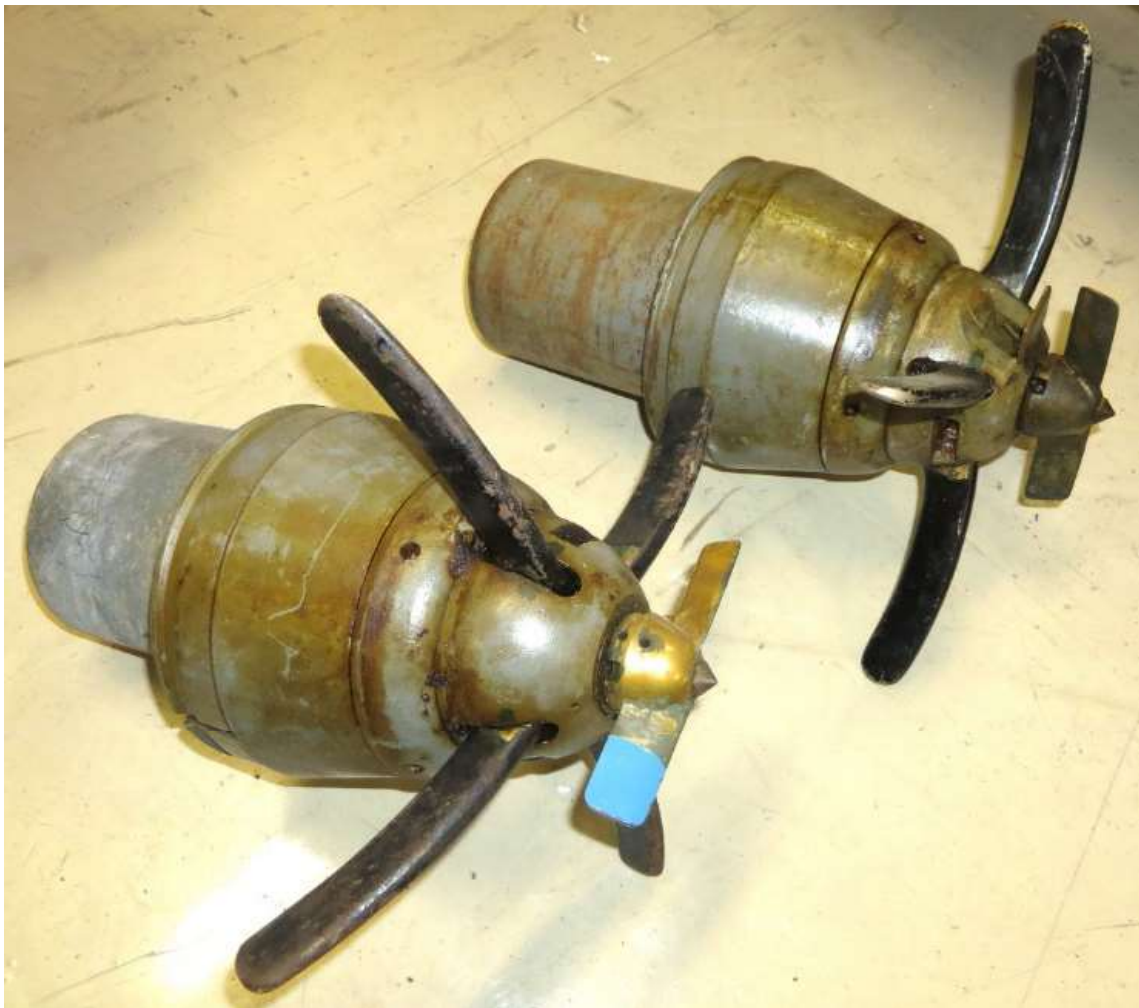
Eksempler på nesemontert mekanisk tennapparat type Pi 1 (Håvard Hovdet)
