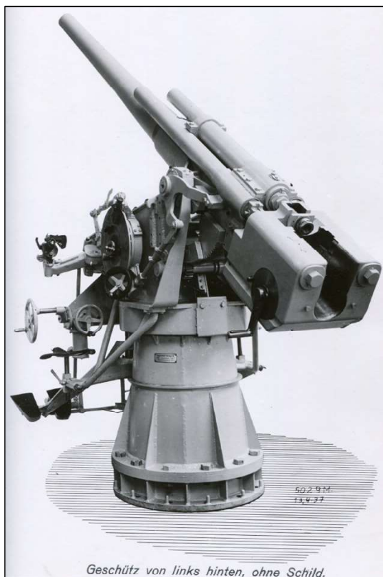
10,5 cm SK C/32 (Merk: Her montert i Mittel-pivotlafette C/30) (M.Dv. Nr. 234,2 via Håvard Hovdet)
